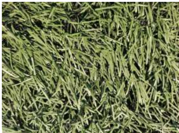
Fiberen har lagt seg på grunn av for lite fyllmateriale, foto fra Tverlandet kunstgressbane
